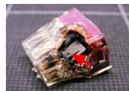
写真 差込み不足による 発熱・焼損例
