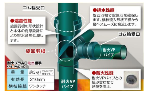
図3 耐火プラADミニ継手
