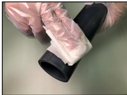
手順2: 接合面の洗浄
