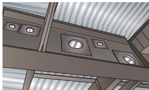
鉄骨梁スリーブの例
