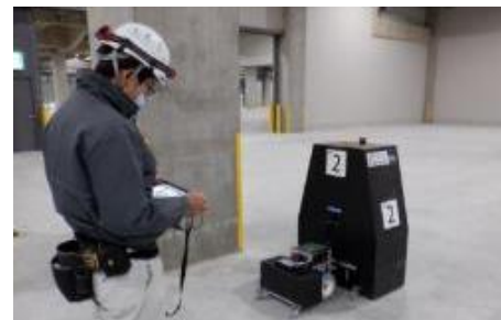
床ひび割れ計測管理 自動ロボットにて計測
