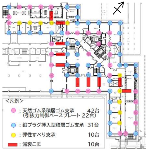
図-3 免震装置配置図
