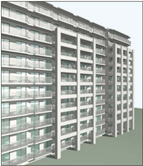
外付け RC フレーム補強（デジタルモックアップ） （計画段階で見え方や季節ごとの日影を検証し、施主と情報共有）
