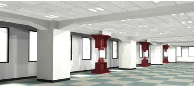
制震間柱設置状況 (間柱外周に設置前)
