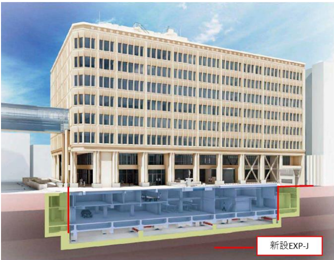
図 2 免震改修後断面イメージ
