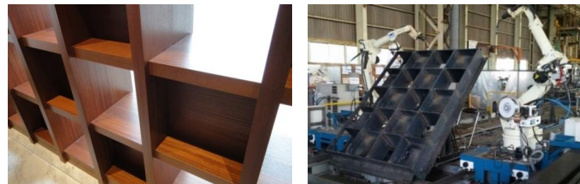
写真-4 耐震市松製作状況
