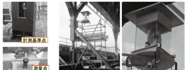
写真2 三次元測量機器
