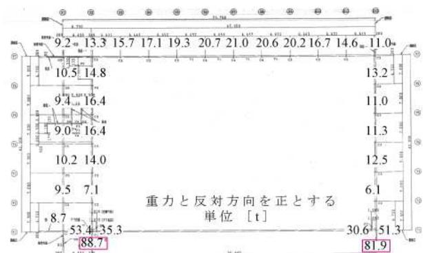
図4 工事着手前の柱脚鉛直反力
