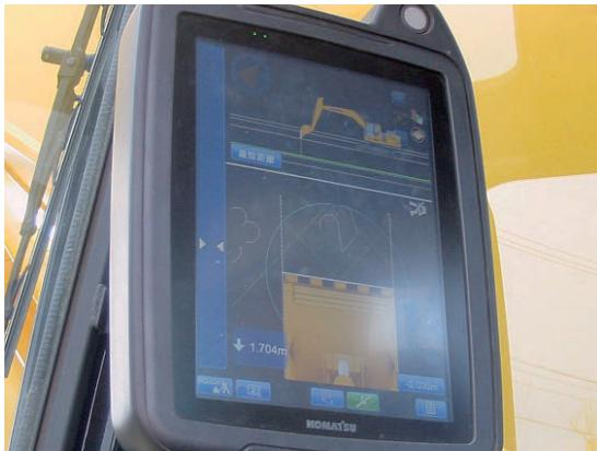
写真-5 モニターによる杭芯確認
