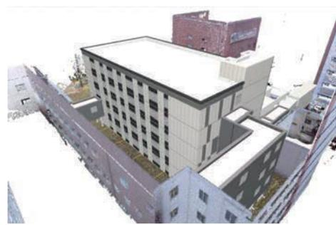
図-3 新築建物 BIM データと既存建家との詳細検証
