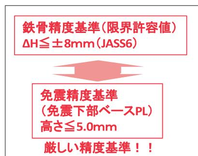
図-9 免震精度基準
