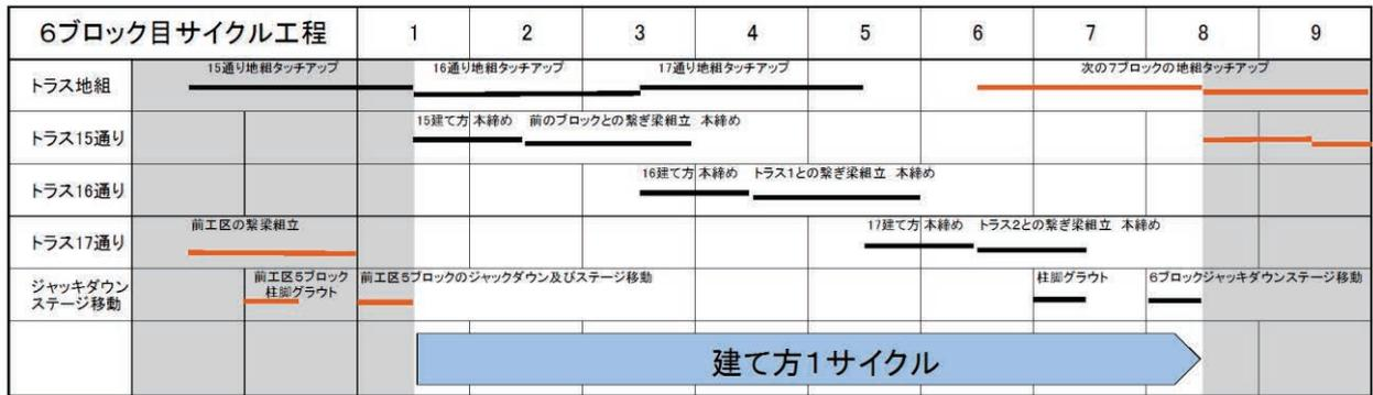
図-16 鉄骨工事工程 ブロックの建て方サイクル
