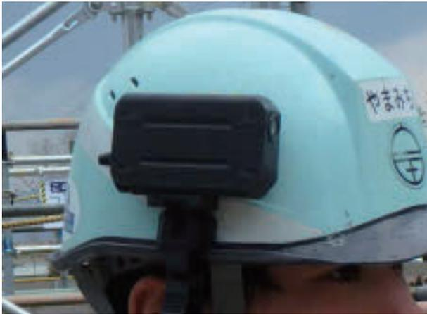
写真-5 ウェアラブルカメラのヘルメット装着状況
