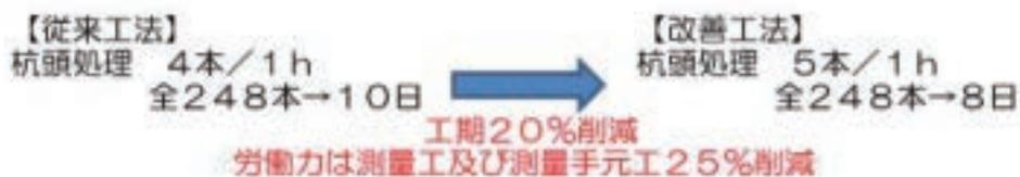
図-7 従来工法との比較（杭頭処理）
