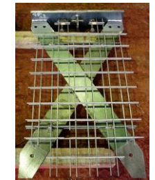
鋼板ブレースと溶接金網
