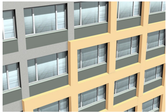
MaSTER FRAME構法の補強イメージ
