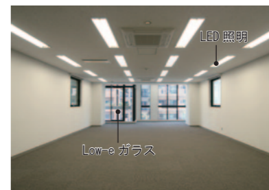
基準階事務所（LED照明・Low-eガラス）
