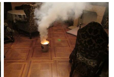
発煙筒による風道実験
