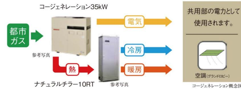
共用部で使用する電力の一部をコージェネレーションシステムにより自家発電。発電時の熱を、冷暖房に有効利用することで節電を図り、空調に伴うCO<sub>2</sub>排出量を削減している。
