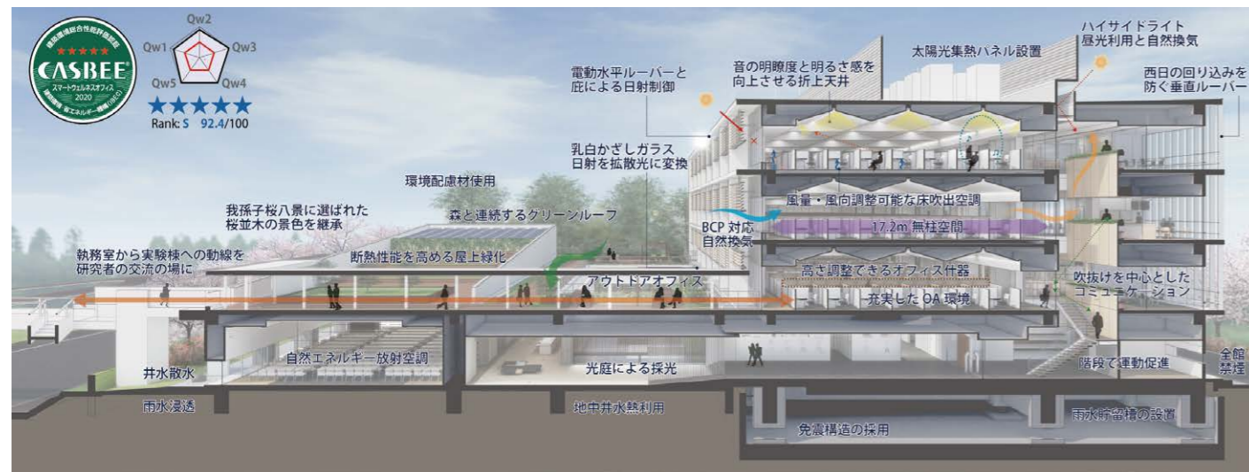
施設断面パース ウェルネスに配慮した様々な取組み
