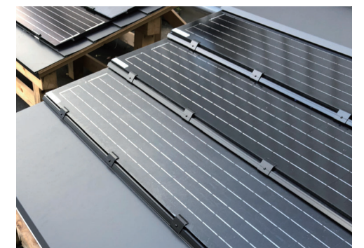
屋根一体型ソーラーパネルのモックアップ検証 防眩性のあるフロスト加工品を採用
