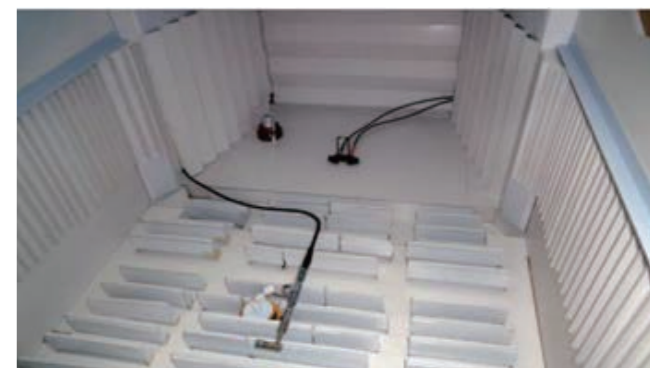
1/30模型を用いた音響シミュレーション
