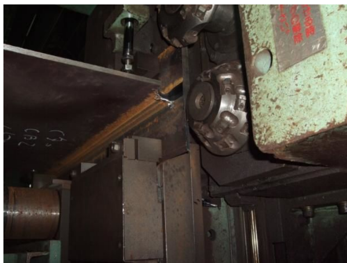
30°レ形開先に対応できる開先加工機
