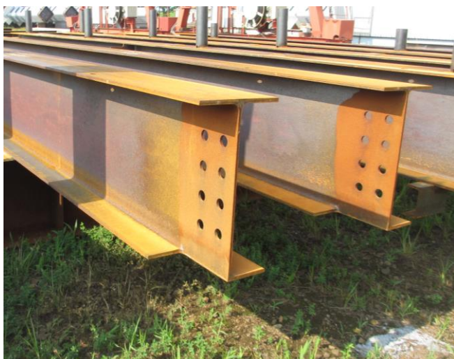
下フランジ片側切断の事例
