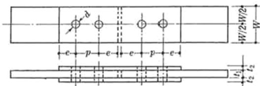
すべり試験用標準試験体の形状・寸法例
