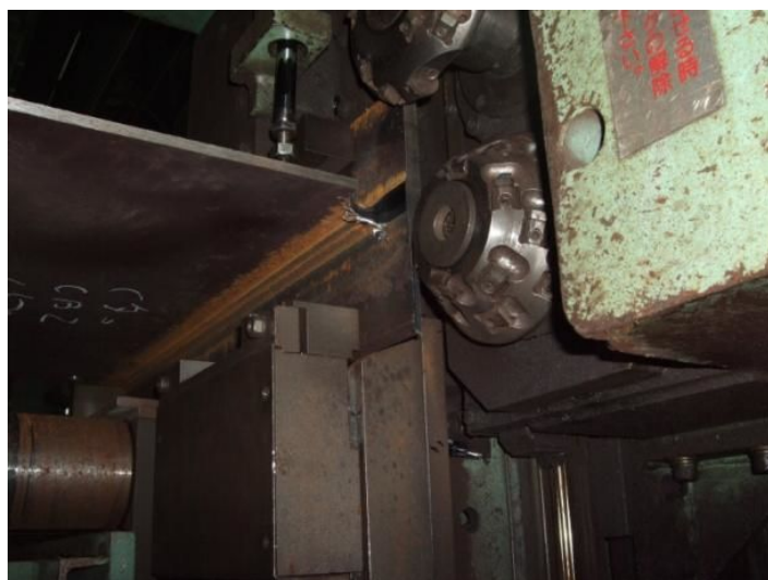
30°レ形開先に対応できる開先加工機
