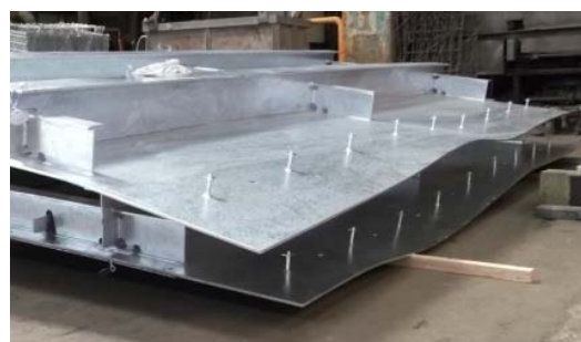
板厚が薄く長尺なため波打ちが生じてしまった例
