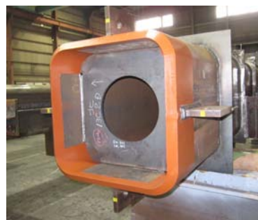
角形鋼管の平部および角部内面に不めっき処理をした例
