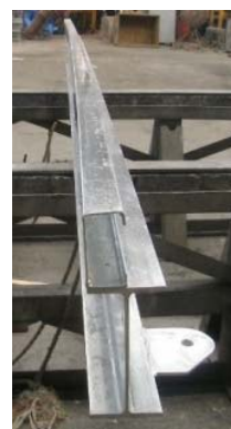
上部片側にだけ部材を溶接したため曲がりが生じた例
