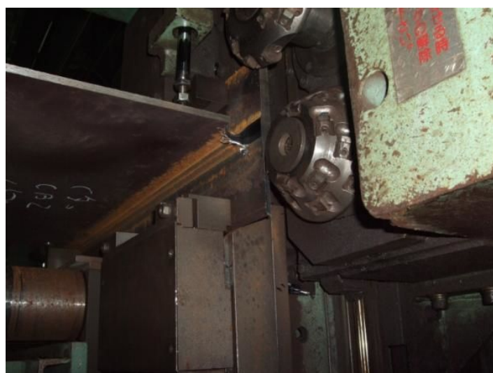
30°レ形開先に対応できる開先加工機
