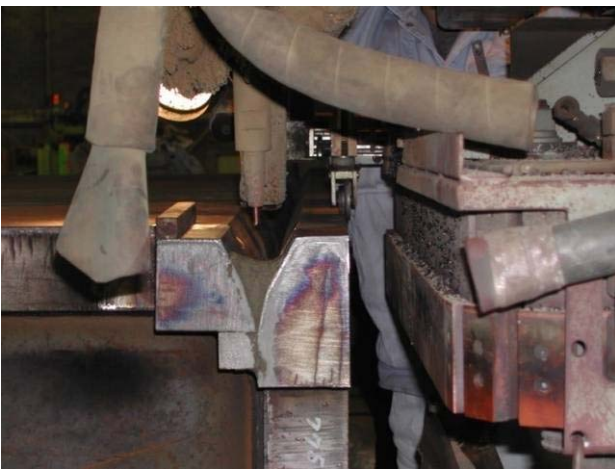
大電流サブマージアーク溶接
