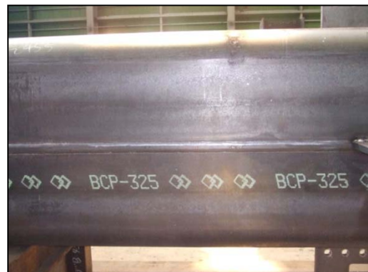
冷間成形角形鋼管(BCP325)
