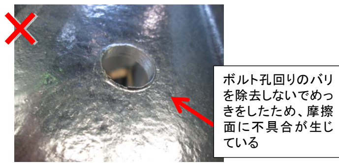
ボルト孔回りのバリ除去不良の例
