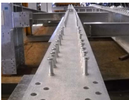
部材の曲がりが生じた例
