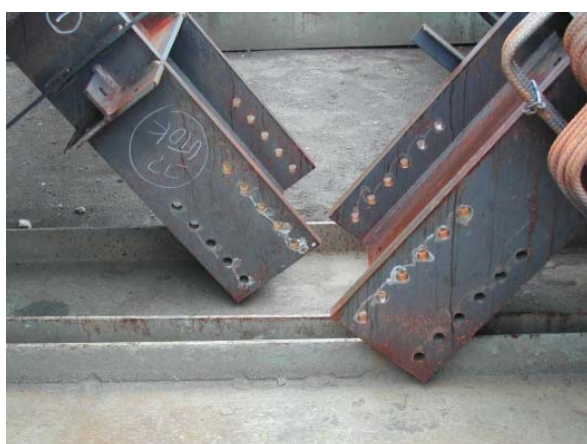
架台が鉄骨なので、製品のウェブが曲がることが多い。
