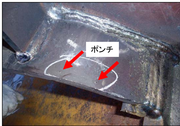
ハンチで曲げ加工される外表面 (写真はポンチを打って曲げ加工された後)
