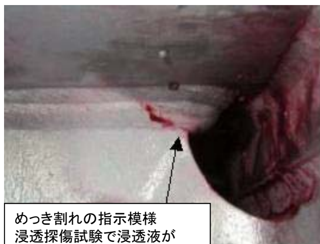
浸透探傷によるめっき割れの検査例 (通常は、目視検査で十分です)
