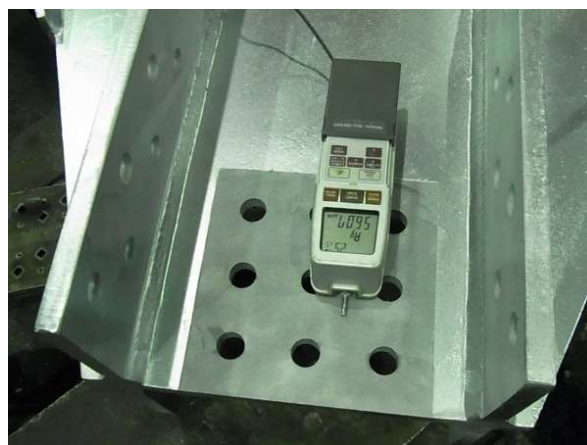
ブラスト処理した摩擦面を 簡易粗さ計で粗さを測定
