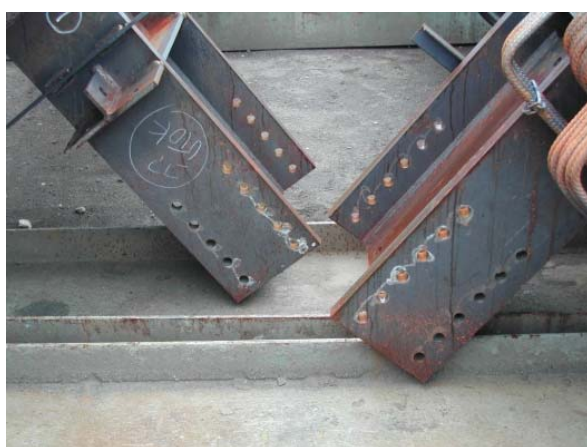
架台が鉄骨なので、製品のウェブが曲がることが多い。
