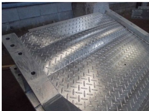
全周溶接した階段踊り場が めっき膨れした例
