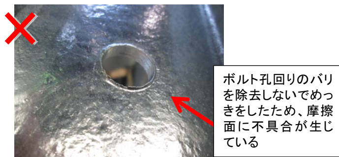
ボルト孔回りのバリ除去不良の例
