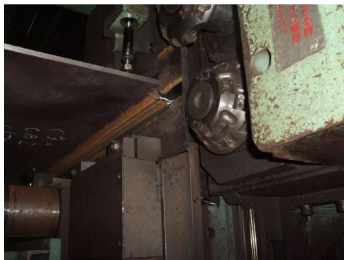
30°レ形開先に対応できる開先加工機
