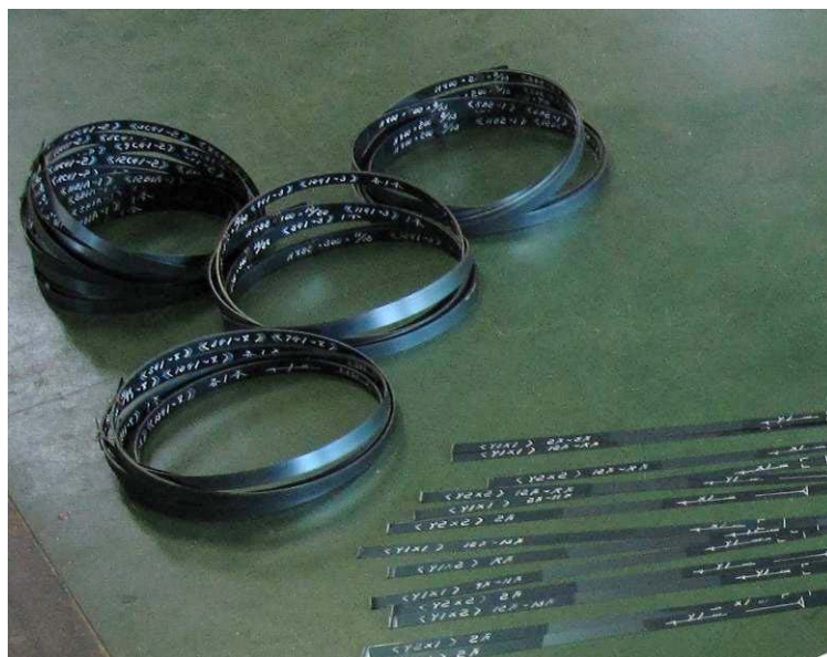
現場でシナイに組立部材位置を記入
