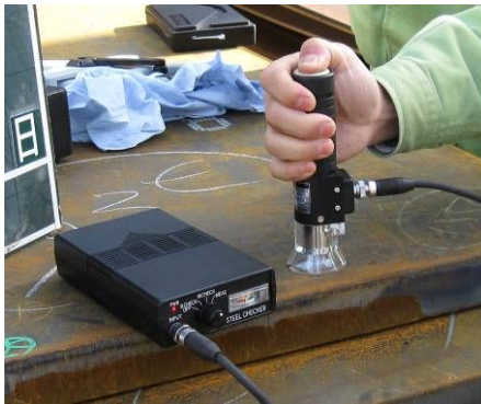
鋼材識別状況
