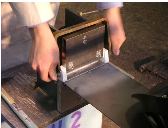
溶接前(代替エンドタブ取付け)
