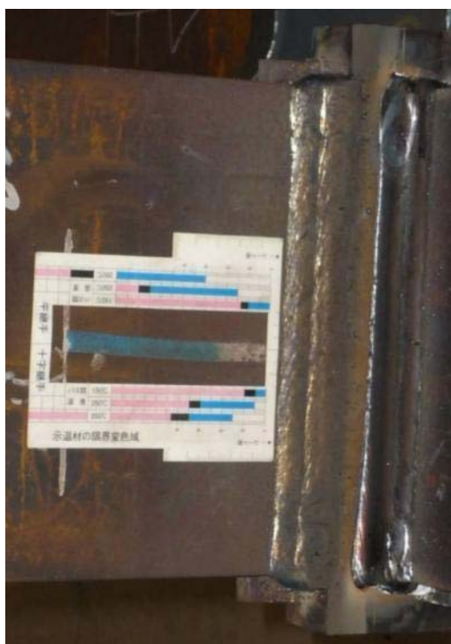
示温塗料を塗布した使用事例
