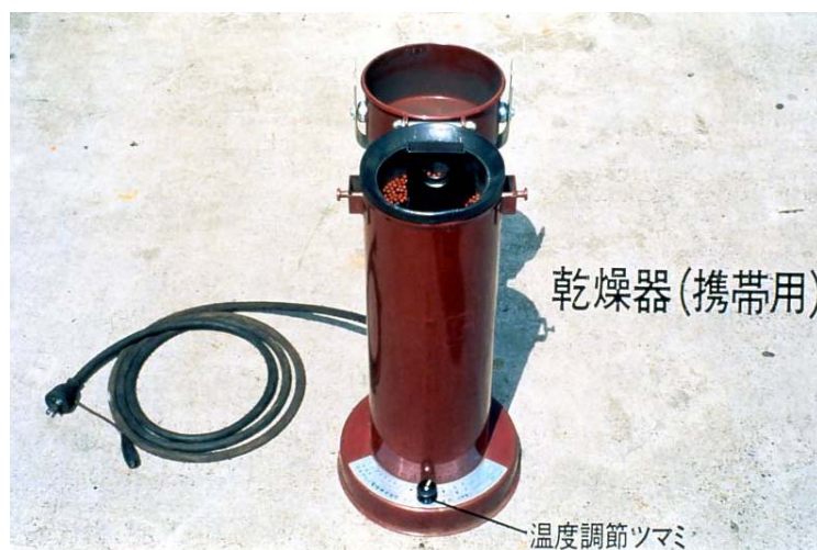
被覆アーク溶接棒の携帯用乾燥器
