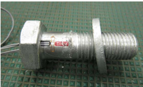
すべり係数試験用にひずみゲージを貼った高力ボルトの例
