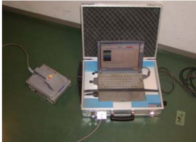
(写真-1) レーダー探査用ノートパソコン
