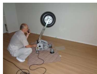
b) 衝撃力特性(1)を有する 標準重量衝撃源
