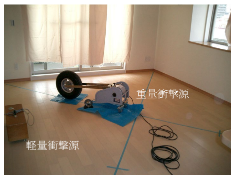
写真 1 床衝撃音遮断性能の測定
