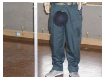
c) 衝撃力特性(2)を有する 標準重量衝撃源
