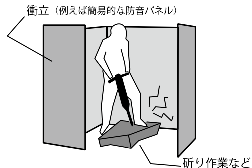
図 2 発生源位置での対策の例
