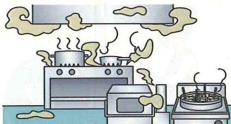
燃焼器を増やしたり、入れ替えた際に、給排気設備の能力が不足すると、給排気不全によりCOを含んだ排気が室内に滞留し、CO中毒の原因になります。
