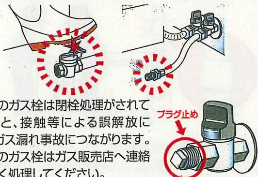
未使用のガス栓は閉栓処理がされていないと、接触等による誤解放によってガス漏れ事故につながります。未使用のガス栓はガス販売店へ連絡し、正しく処理してください。
