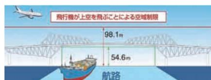
航路を跨ぐ主橋脚間は440m。橋桁の上下に発生する高さ制限からトラス構造が採用された。（資料提供：国土交通省 東京港湾事務所）
