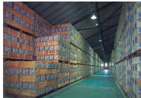
倉庫棟内部。そうめんが高く積まれている。この場所ですべて2年間ねかせ。梁は細い鉄パイプによるトラス構造。
