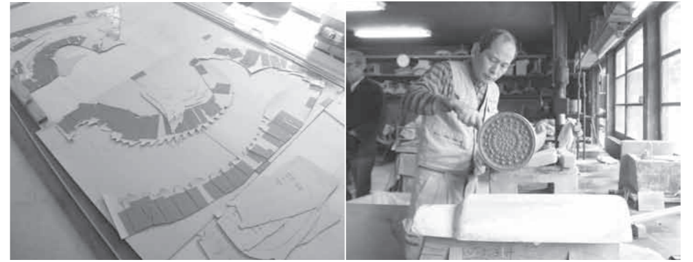
左/姫路城で使われる「鯨」の図面。最終的なできあがりの寸法を示す「原寸図」とは別に、乾燥と窯焼きによる収縮を見越して大きめに作るための「生寸図(なますんず)」も必要だ。 右/「軒丸瓦」の製作。工房では、姫路城のみならず、唐招提寺・東本願寺・正倉院、さらには韓国の寺院まで、さまざまな文化財の屋根瓦が丹念に造られている。
