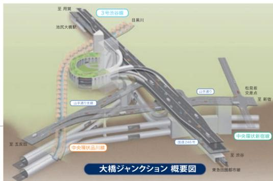
五反田方面からの品川線が大橋ジャンクションに接続する連絡路トンネルを構築。また、新宿方面からの新宿線と連絡路トンネルを合流させる。(提供：首都高速道路株)
