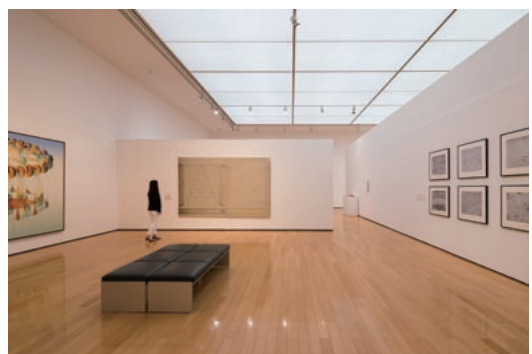
第4展示室。天井は光天井。自然光と人工照明を混合する自動調光システムを採用。
