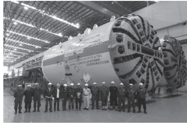
トムソン線で使用するトンネルボーリングマシン (TBM)
