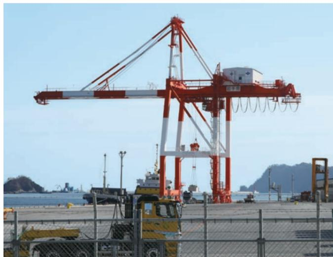
震災前の港湾機能を確実に取り戻している。さらに新設備の整備も進む。「大阪府のご厚意で岩手県が無償提供を受けた県内初の高機能コンテナ荷役機械であるガントリークレーンが昨年九月から稼働を始めています。釜石港でコンテナの定期航路を開設したのは震災があった年の七月。これ以降、コンテナの取扱量が順調に増加し、二〇一五年には岩手県の最高記録を塗り替えました。こうした状況から現在の荷役機械では対応できなくなり新しいクレーンの整備が必要になりました」と説明してくれたのは釜石市産業振興部港湾振興課の藤井充彦課長だ。昨年、釜石港の一般貨物コンテナの年間取扱量は、県内港過去最多を記録。牧草や自動車部品、ホームセンターの商材などの取扱いが好調に推移する中、従来のジブクレーンに比べて三倍の荷役機能を誇るこのガントリークレーンの導入によって、更なる集荷が見込まれるという。
