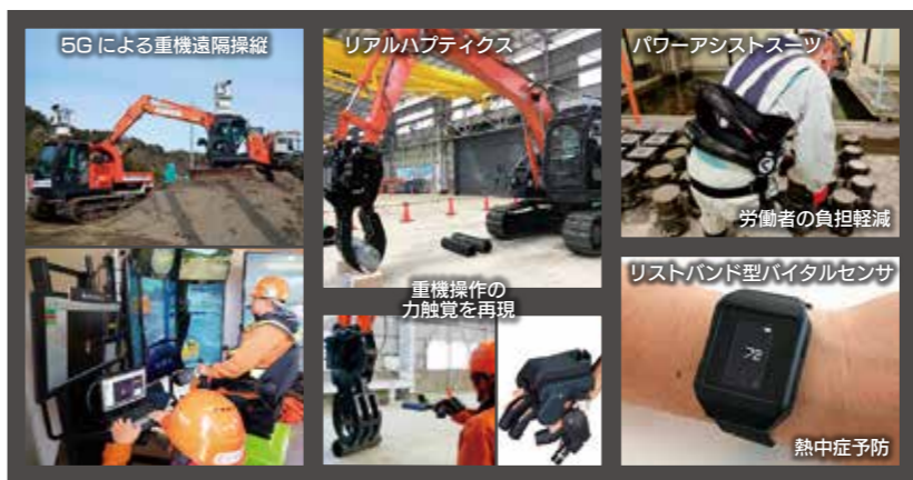
センシング技術やウェアラブル端末を活用した建設DXの取組み(提供: 株大林組)
