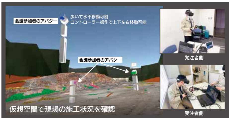
発注者と施工関係者がデジタルツインで再現された現場に没入して3D臨場や会議を実現(提供: 五洋建設株)
