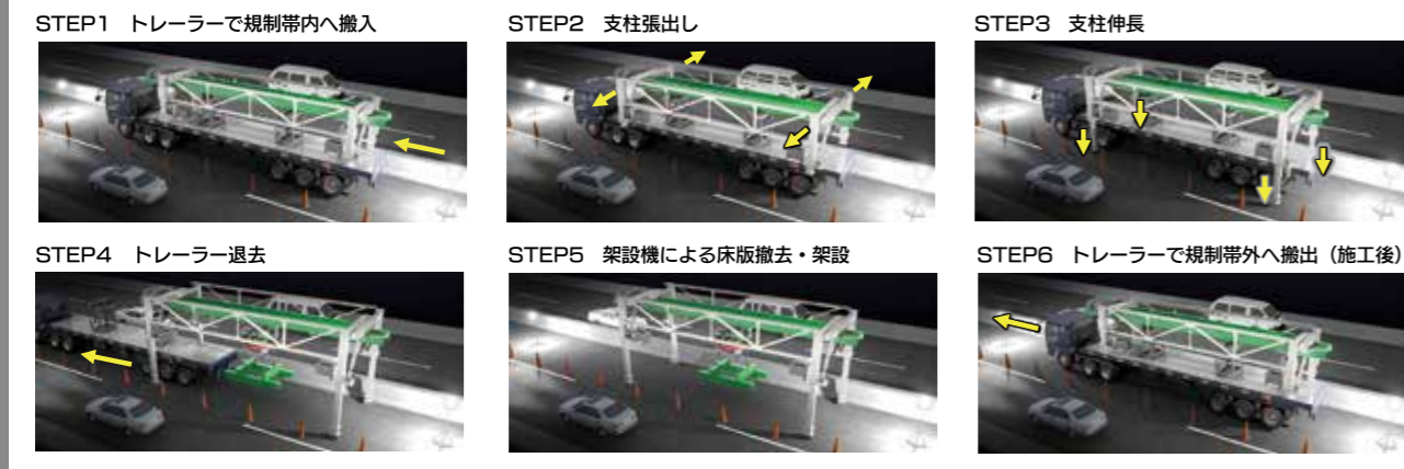
1. 従来工法との交通規制の比較 2. 半断面架設機「ハイウェイストライダー」搬入～搬出手順
