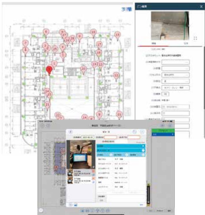
仕上検査業務に特化したクラウドサービス「LAXSY」。1枚の検査シートを複数で共有できる。(画像提供：大成建設㈱)
