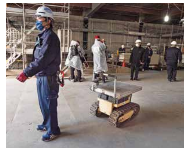
歩く人の後を追尾して、資材などを自動で運搬できるロボット。
