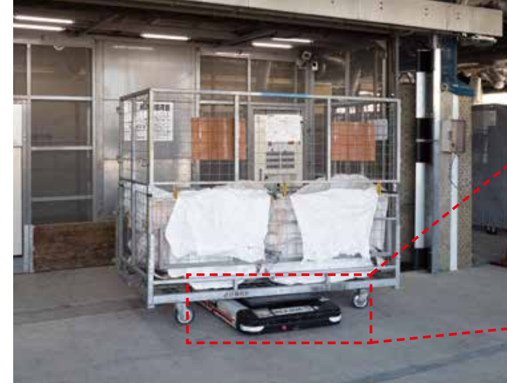
自動搬送ロボット。エレベーターと連動し、水平だけでなく垂直方向にも資材を搬送できる。
