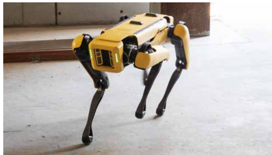
現場内の段差や階段も走破可能な四足歩行ロボット。自動巡回にも遠隔操作にも対応できる。
