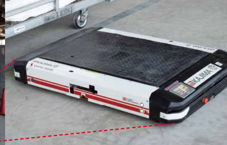
自動搬送ロボット。エレベーターと連動し、水平だけでなく垂直方向にも資材を搬送できる。
