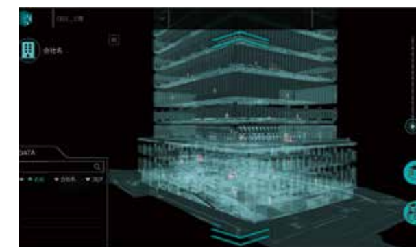
リアルタイム現場管理システム「3D K-Field ® 」。建物のデジタル情報を活用して現場の遠隔管理を支援する。(画像提供:鹿島建設株)
