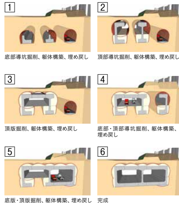
低土被り区間における函体構築の施工ステップ。(提供: 鹿島建設株)
