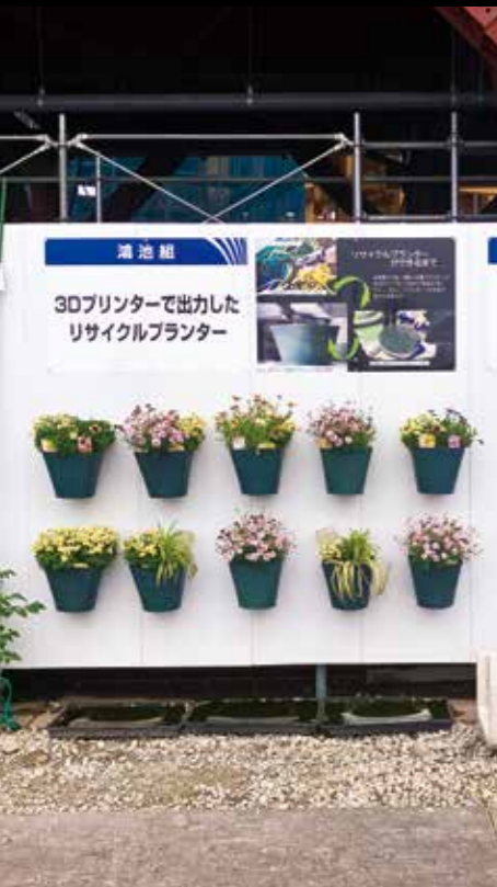
右上/B100燃料を使用したクローラークレーン。右下/アクアメイク®の概念図。利用過程で発生した窒素とリン酸を含む余剰水を植栽の水に活用。左/現場で大量廃棄されるPPバンドを原料に再製したプランター（いずれも提供：株鴻池組）
