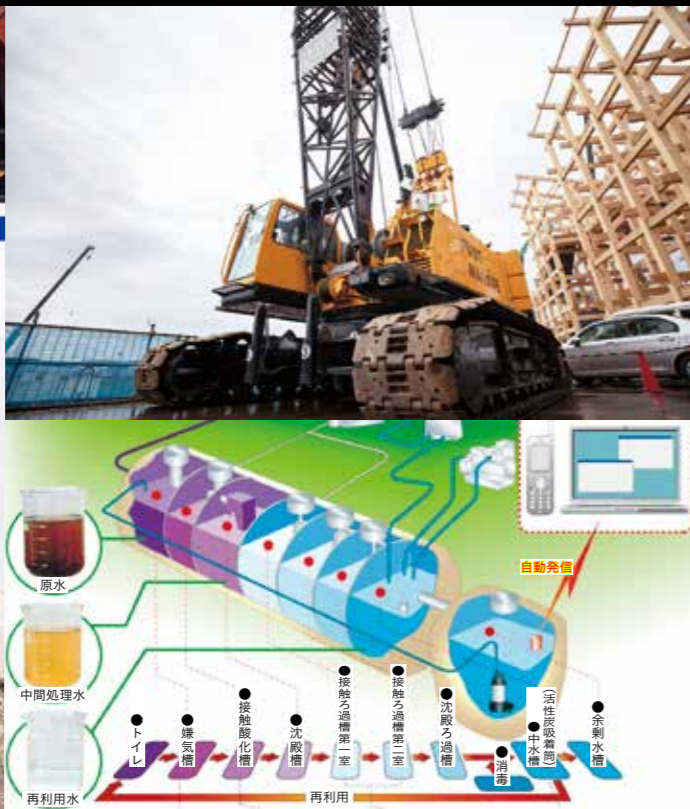
右上/B100燃料を使用したクローラークレーン。右下/アクアメイク®の概念図。利用過程で発生した窒素とリン酸を含む余剰水を植栽の水に活用。左/現場で大量廃棄されるPPバンドを原料に再製したプランター（いずれも提供：株鴻池組）
