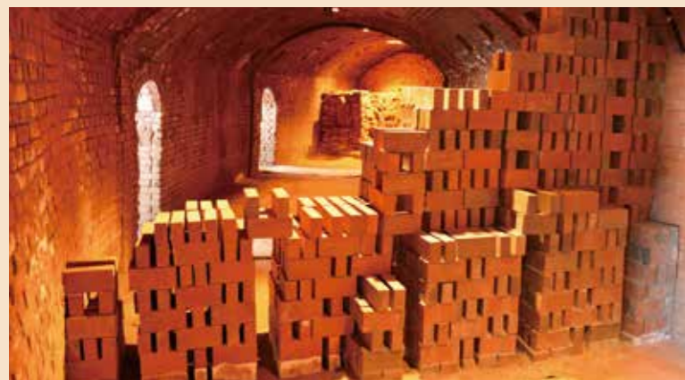
窯内部の様子。焼成室は全16室あり、通常1室で約14,000個、全室で約22万個の煉瓦が焼成可能。製造された赤煉瓦は、北関東を中心に、東京へも出荷された（提供：野木町役場教育委員会）
