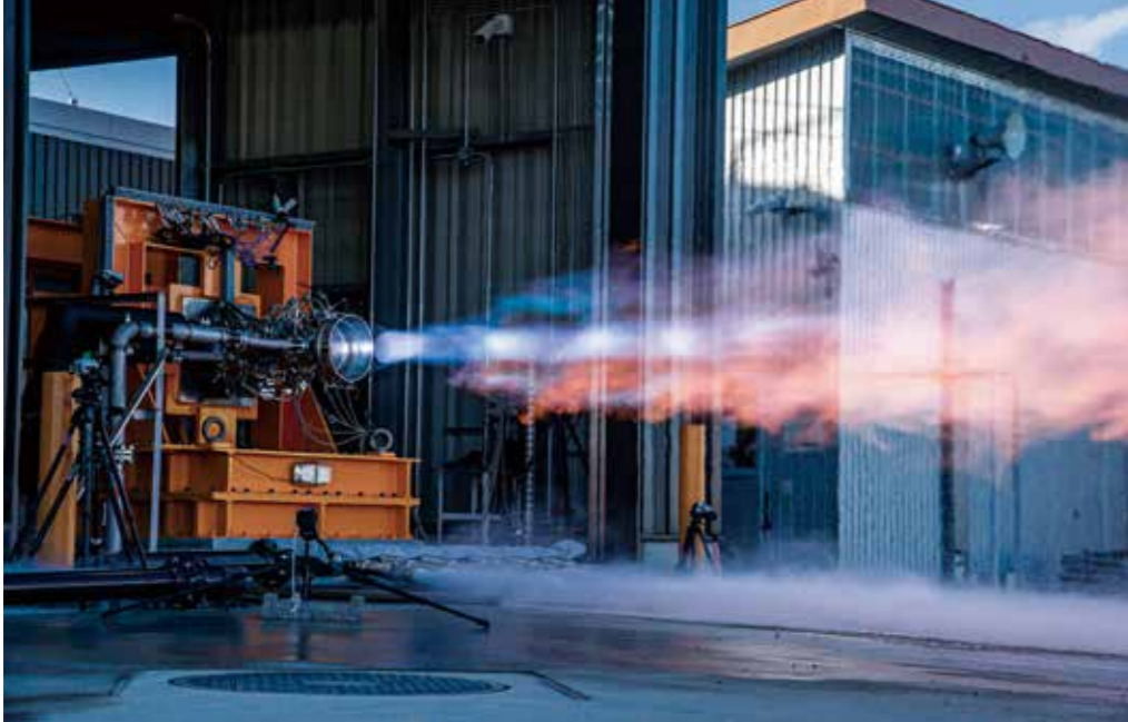
インターステラテクノロジズが開発中の小型人工衛星打上げロケットZEROのエンジン燃焼器単体試験の様子(提供:インターステラテクノロジズ株)
