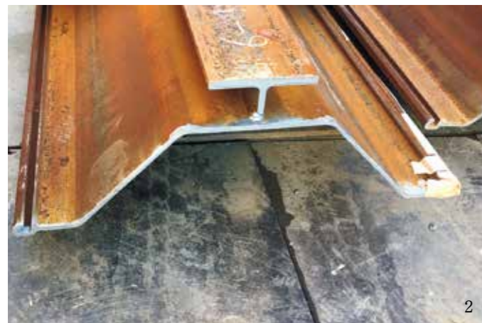
1. プレキャスト柱の建て起こし状況 2. J-WALL II 鋼矢板の断面ディテール 3. J-WALL II 床版・壁鉄筋組立状況
