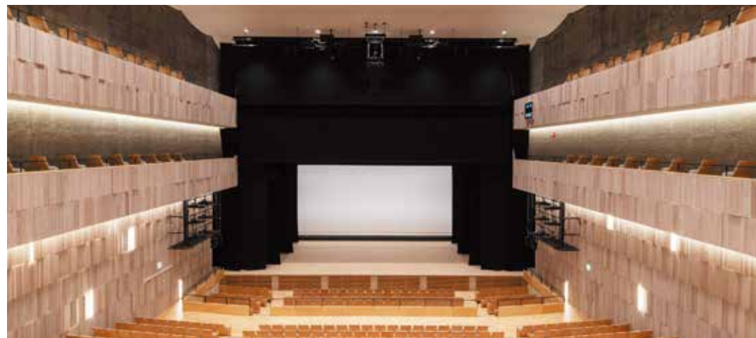
ホールの形状は長方形の一边をステージとし音響効果を優先したエンドステージ型だが、舞台幕を設置して舞台を額縁のように切り取るプロセニアム型(下)にも転換できる。双方の型式で最良の響きを生み出すため、音響反射板の構造や可動式天井の収納などについて検証と議論が繰り返された
