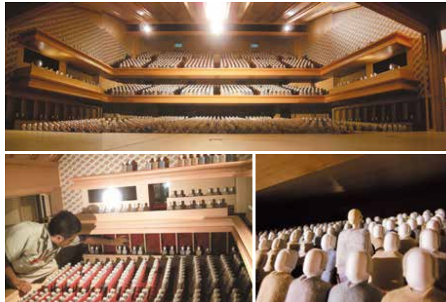
2013年に竣工した第五期歌舞伎座の建替えでは1/10の模型を作成し、4カ月かけて音響性能の確認、実験を行った。消防法や客席の増設など制約があるなか天井や壁面の形状、材料に試験結果を反映させて第四期歌舞伎座と同等の響きを再現した
